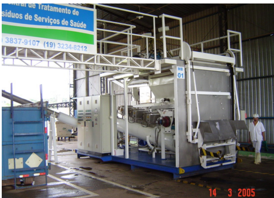
Figura 3 - Sistema de desinfecção por microondas, Campinas, SP
